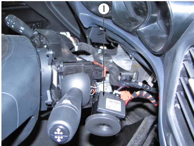
Рисунок 1-5 – Расположение антенны иммобилизатора (кожух рулевого вала снят):
